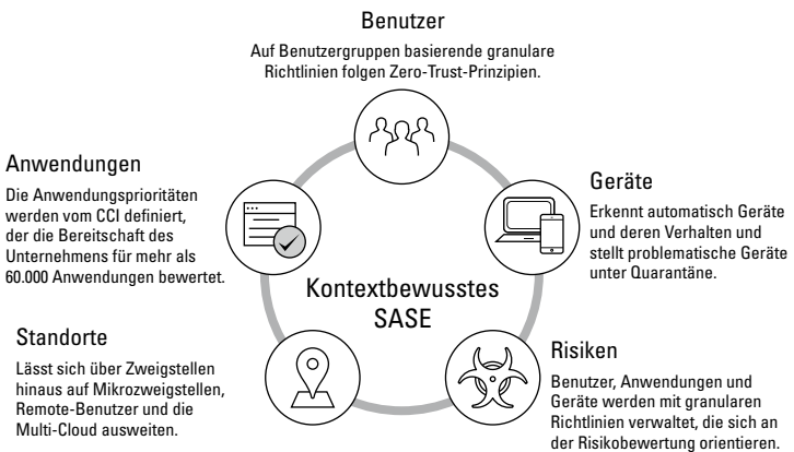
ABBILDUNG 5-1: Ein auf Benutzer, Geräte, Anwendungen und die damit verbundenen Risiken ausgerichteter, umfangreicher Kontext ist eine unabdingbare Voraussetzung für die Festlegung granularer SASE-Richtlinien.
